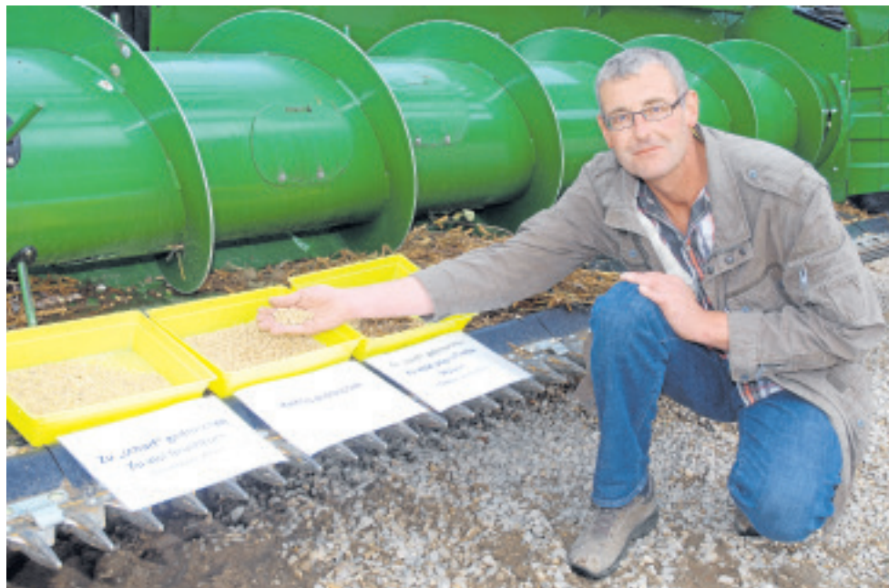
Jürgen Unsleber vor dem Erntegut: In der linken Schale wurde zu „scharf“ gedroschen, das Erntegut enthält viel Bruchkorn. In der rechten Schale liegen noch viele ungeöffnete Hülsen, hier wurde zu „weich“ gedroschen. In der Mitte wurde richtig gedroschen. | Foto: Gebendorfer
