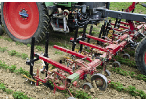
Hier ein Hackgerät für den Zwischenachsenbau, das Gänsefußschare und Fingerhacke kombiniert.
