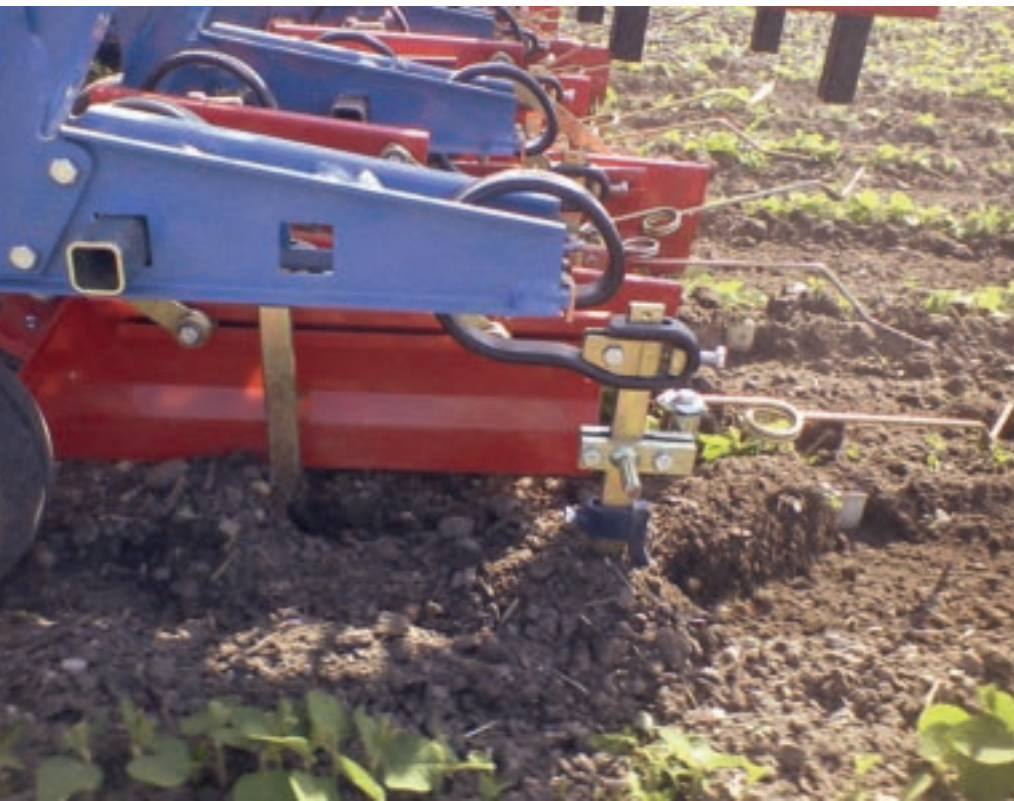
Zusatzwerkzeuge, hier der Flachhäufler, verbessern die Arbeit der Hacke.
