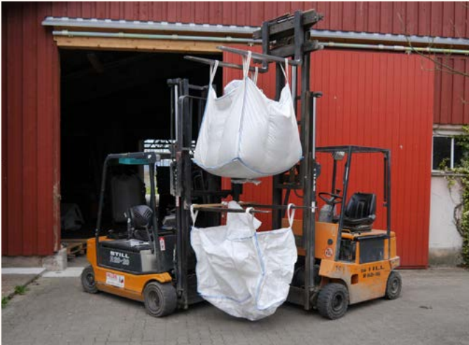
Wenn die Stapler in 90° zueinander stehen, lässt es sich am besten an den Bigbags arbeiten
