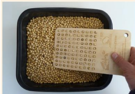
Abbildung 2: Den größten Aufwand stellt beim Einweichtest das Abzählen der 100 Bohnen dar. Abhilfe schafft ein einfacher Bohnenzähler.
